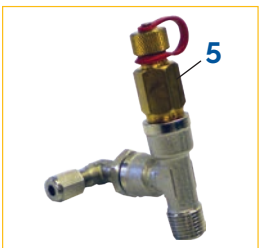
KEKO.002 Raccord en T 1/4MFF, reducción 1/4M - 1/8F , raccord de compresión 1/8M, tubo capilar en rollo diámetro 4 mm longitud 2 m, toma de presión M1/4. Tee 1/4MFF fitting, 1/4M-1/8F adapter, compression fitting 1/8M, 1/4M test plug.
