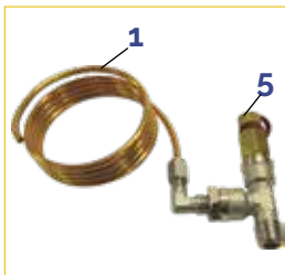
KEKO.001 Raccordo a T 1/4MFF, riduzione 1/4M - 1/8F, raccordo a compressione 1/8M, tubo capillare in rame diametro 4 mm lunghezza 2 m, presa di pressione M1/4. Lunghezze diverse a richiesta.
