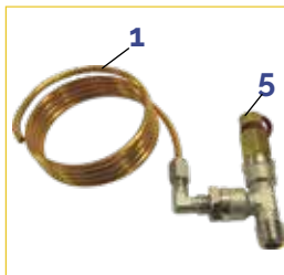
KEKO.001 Raccordo a T 1/4MFF, riduzione 1/4M - 1/8F, raccordo a compressione 1/8M, tubo capillare in rame diametro 4 mm lunghezza 2 m, presa di pressione M1/4. Lunghezze diverse a richiesta. Tee 1/4MFF fitting, 1/4M-1/8F adapter, compression fitting 1/8M, copper capillary pipe diam. 4 mm 2 m length, 1/4M test plug.
